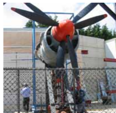
Stanowisko badawcze firmy Taylor Woodrow do badania obciążenia wiatrem – (powyżej)
