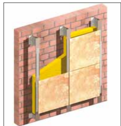
Typowe elementy konstrukcji fasady wentylowanej.
